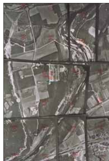
Punts de recolzament i de control sobre fotografia aèria en b/n.
