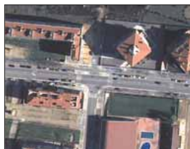
Comparació de dues imatges, una analògica (dalt) i una altra de digital (baix), amb la mateixa mida de píxels i capturades en el mateix moment. La imatge digital ha estat presa amb la DMC mentre que l'analògica amb la RC30 i escanejada a 15 micres (paràmetres habituals per a la fotogrametria aèria).
