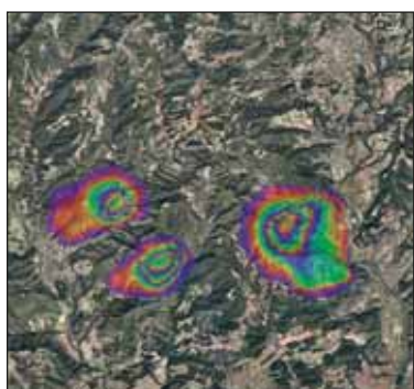
Fases de l'interferograma diferencial corresponent a les dades 3 febrer i 19 de maig de 2005 a la conca potàssica del Bages. Cada cicle de color correspon a un gradient de desplaçament de 2,8 cm.
