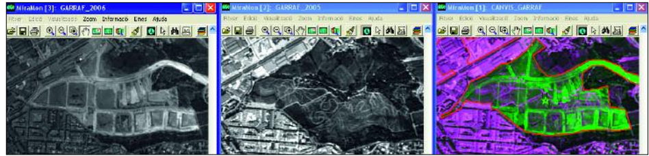
Procés de detecció de canvis utilitzant imatges SPOT. En aquest exemple es detecta un canvi de coberta vegetal amb moviment de terres.
