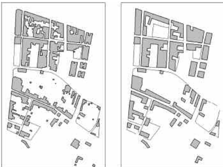
Exemple de simplificació d'edificacions. A l'esquerra es mostren les dades originals i a la dreta les dades generalitzades.
