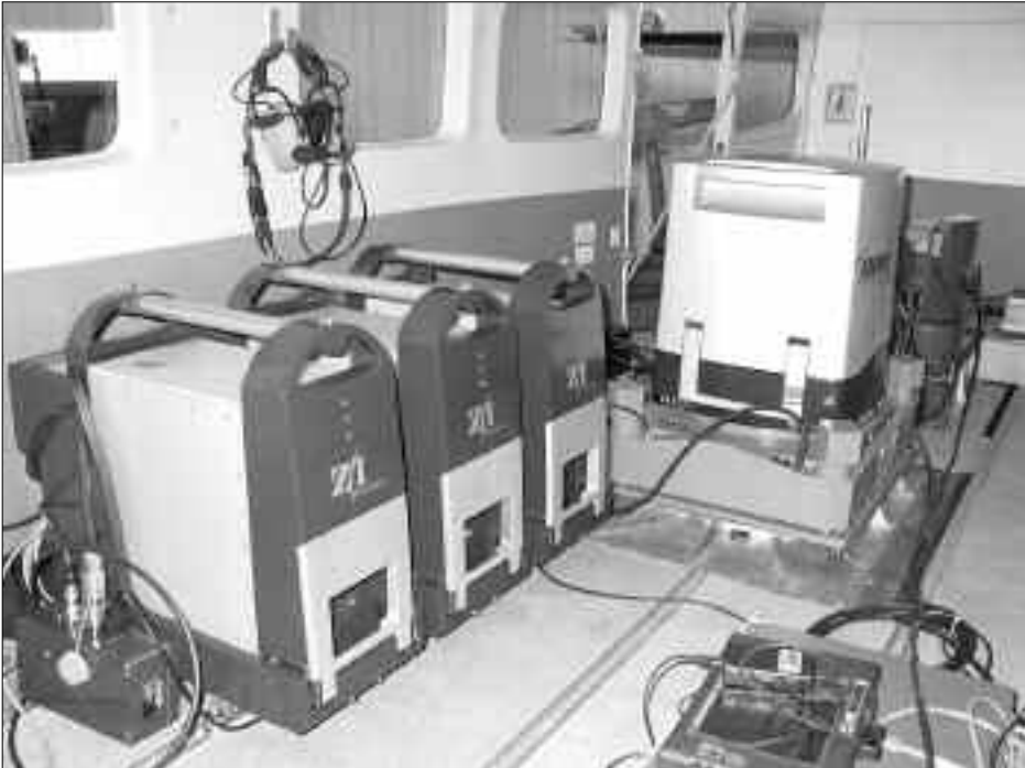
Càmera DMC001-014 instal·lada al Cessna Caravan 208 de l'ICC.
