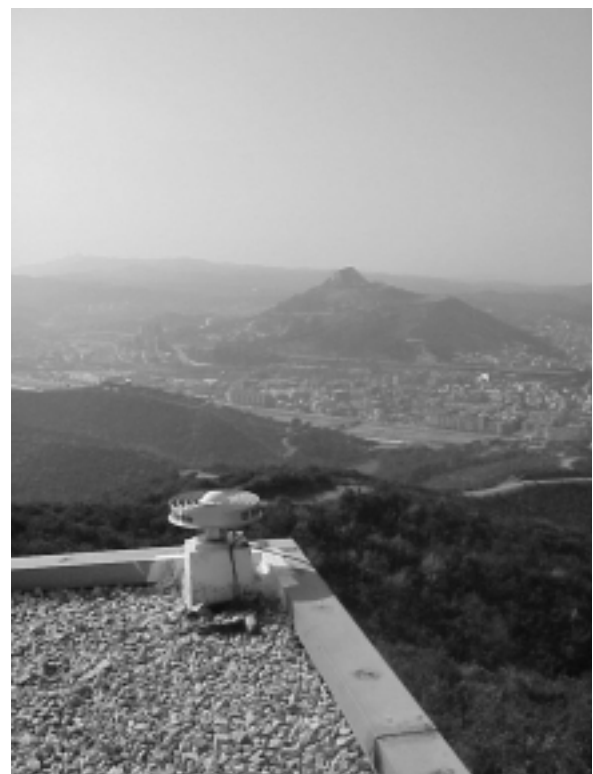
CatNet. Estació fiducial GPS a Montcada
