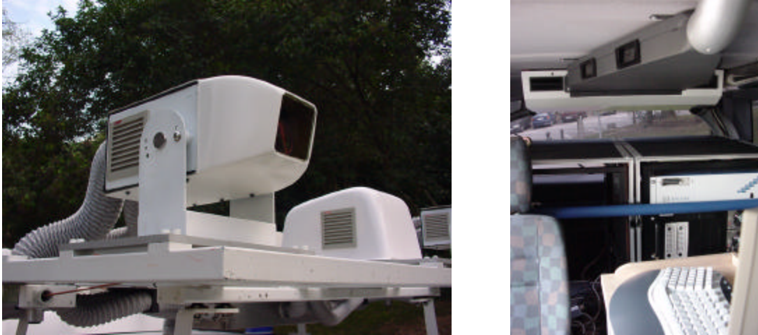
Figura 11: Protecciones ambientales y bloque evaporador del sistema de climatización.
