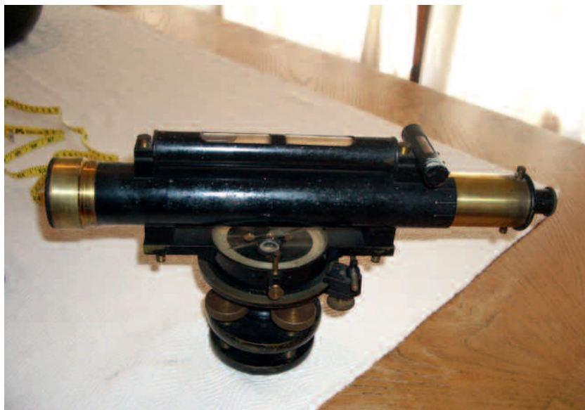
Figura 6. Nivell de precisió o “teodolit terrestre” emprat pel maestro de obras militares , Pere d’Alcàntara Peña. Incorpora una búixola pivotant solidària amb un cercle graduat ajustable, un caragol micromètric i dos nivells de bombolla. L’ullera estesa té 28 cm. (Font: Hereus d’en P. d’A. Peña).
