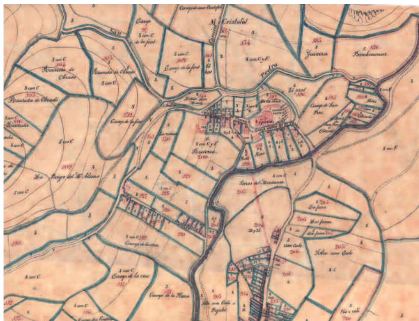
Figura 4. Detall del plànol parcel·lari de Mieres (1885) a escala 1:2 500, obra de Joan Papell i Llenas. Nucli de Sant Pere i, a baix, part del Carrer de Can Queló. Remarqueu la utilització de corbes de nivell aproximades. Imatge facilitada per l'Ajuntament de Mieres.
