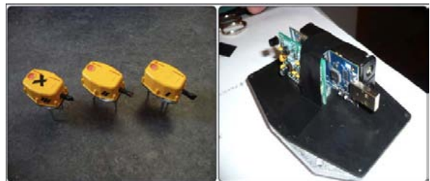
Figura 3 – Imatge del sensor inalàmbric desenvolupat i el seu encapsulament.
