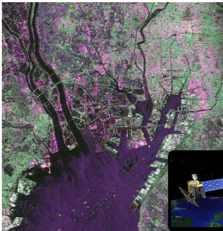
Imatge generada pel sensor PALSAR del satèl·lit ALOS (R:G:B HH:HV:VV) de la zona de Nagoya (Japó) (facilitada per JAXA EORC).
