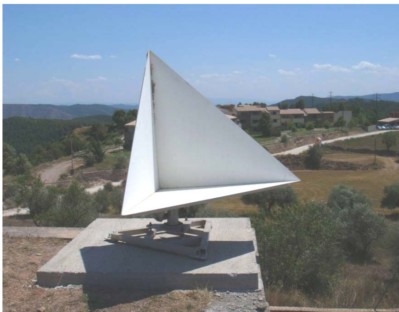
Triedre reflector per al seguiment de les subsidències en zones de baixa coherència.
