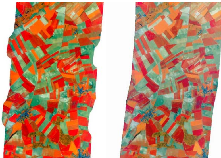
Efecte de les condicions geomètriques i atmosfèriques a la mesura radiomètrica de les imatges CASI.
