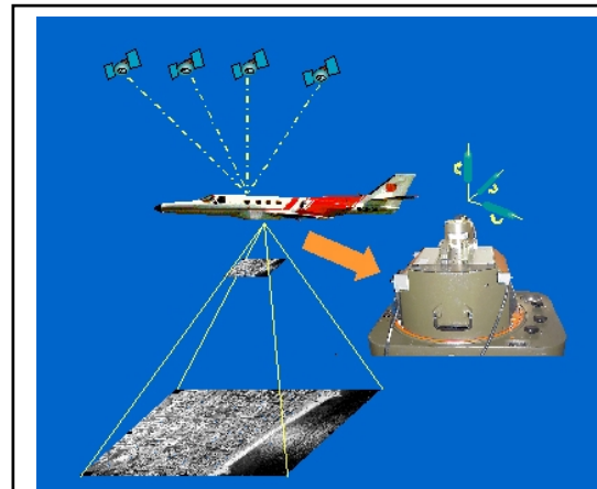
Esquema que representa la georeferenciació directa integrant observacions GPS i inercials
