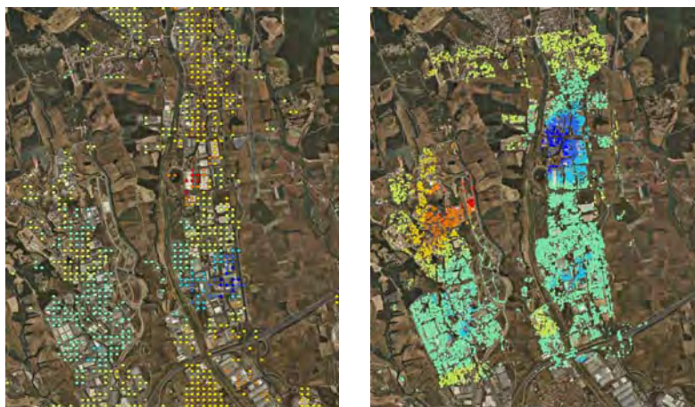
Subsidències a partir d'imatges ENVISAT i TerraSAR-X a Palau de Plegamans.
