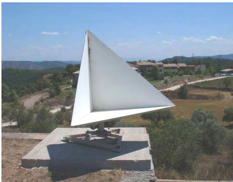
Tríedre reflector per al seguiment de les subsidències en zones de baixa coherència.
