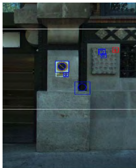
Exemple de captació automàtica de senyals de circulació a partir de les imatges preses pel sistema GEOMOBIL. Exemple de detecció d'un gual.
