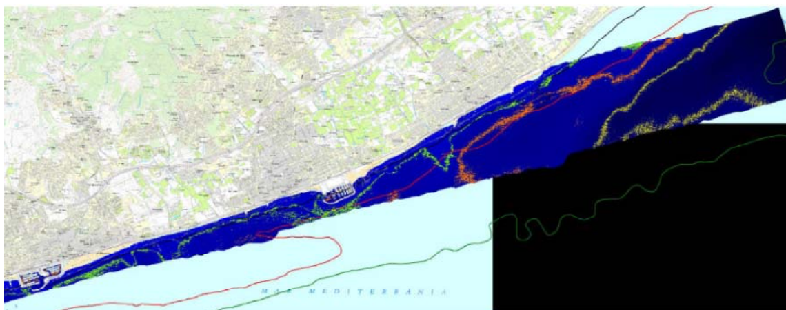
Imatge amb els resultats del processament hiperespectral i aplicació del model de fons per a obtenir les corbes de batimetria (sobre mapa topogràfic a la zona del Maresme – Mataró).
