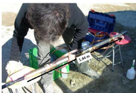
Esquerra: Fotografia de la sonda HIRAT amb la longitud de la sonda (de cap de la sonda fins al sensor). Dreta: Finestra de treball d'un log 3D amb la funció 3D Borehole.
