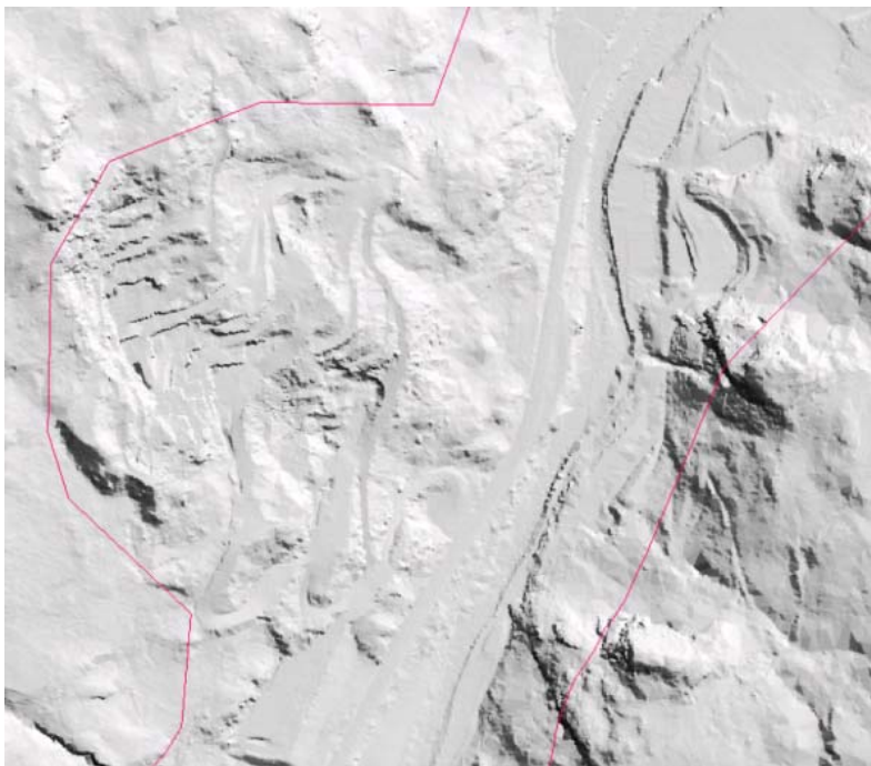
Detall de MDT de la Garona del vol combinat DMC i lidar.
