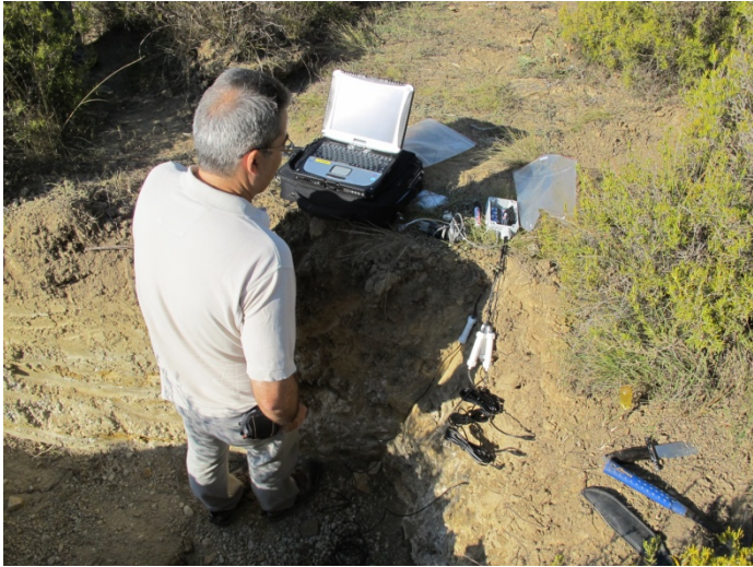
Instal·lació del sensor enterrat d'una de les sondes de mesura d'humitat i temperatura del sòl.
