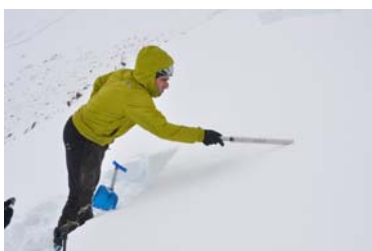
Obtenció de mostres de l'estat del mantell nival per obtenir índexs d'inestabilitat correlacionables amb l'ocurrència d'accidents per allaus.
