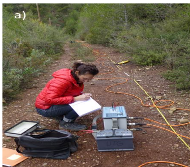
a) Fotografia corresponent a l'adquisició de dades de tomografia elèctrica del perfil PG04. S'observa el resistivímetre amb els cables connectats i els elèctrodes localitzats a cada posició de mesura. b) PG01. Sismòmetres (caixes grogues) amb els cables sísmics connectats. Els geòfons amb carcassa vermella es disposen al llarg del perfil.
