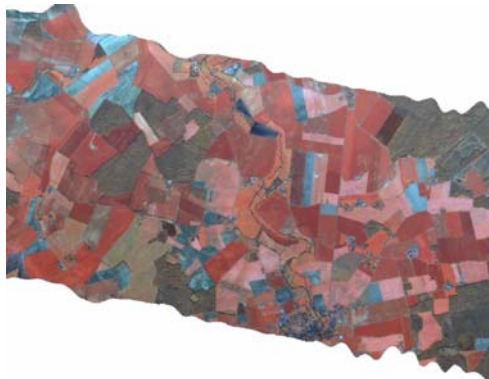
Imatge de sensor hiperspectral AISA EAGLE II de l'ICGC obtinguda el 7 d'abril del 2014 a França amb l'avió Beechcraft. (Combinació en fals color de 3 bandes, la primera col·locada en l'infraroig proper de l'espectre, la segona en el vermell i la tercera en el verd).
