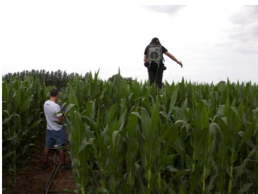
Mesures sobre un camp de blat de moro amb un espectre-radiòmetre de camp.
