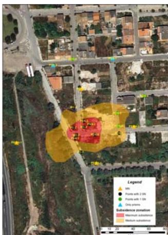
Zonació de la subsidència i pla general de la distribució de nodes Wi-Gim.
