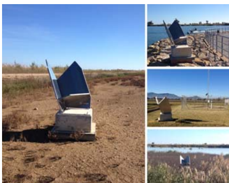
Instrumentació per a l'estudi de subsidències al Delta de l'Ebre.
