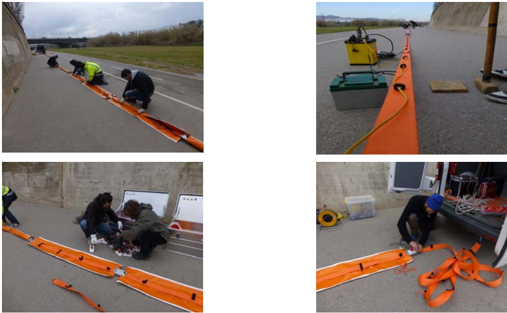
Imatges de la posada a punt i prova del land-streamer.
