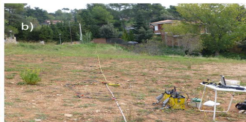
a) Fotografia corresponent a l'adquisició de dades de tomografia elèctrica del perfil PG04. S'observa el resistivímetre amb els cables connectats i els elèctrodes localitzats a cada posició de mesura. b) PG01. Sismòmetres (caixes grogues) amb els cables sísmics connectats. Els geòfons amb carcassa vermella es disposen al llarg del perfil.
