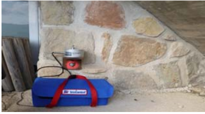
Fotografia d'una sismòmetre Instantel instal·lat en un habitatge de Bigues i Riells per al registre de vibracions induïdes per voladures. La maleta blava conté el digitalitzador.
