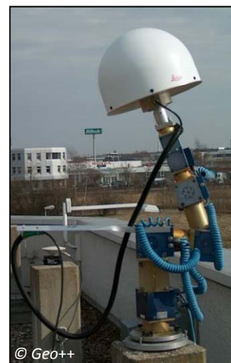
Figura 1. Robot emprat en el calibratge absolut.
