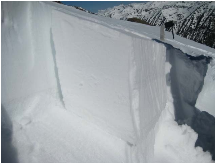
Figura 86: Detall del perfil realitzat, on es veu clarament el nivell de lliscament a l'efectuar un test de sobrecàrrega. Font: CGA.
