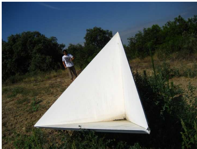
Imatge d'un dels "corners reflectors" instal·lats a Cardona (Bages) per a l'estudi de la subsidència
