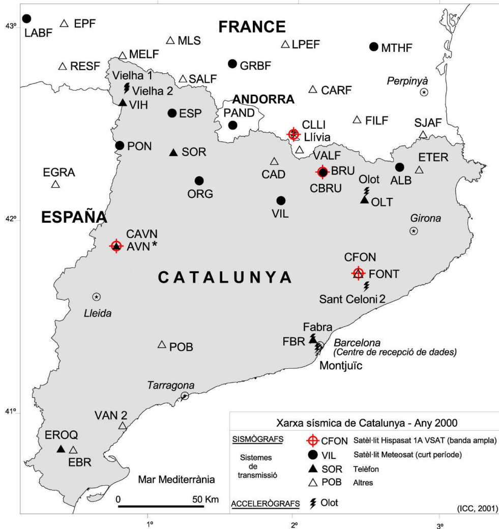
Figura 1. Situació de les estacions sísmiques, a l'any 2000, a Catalunya i regions veïnes. S'indiquen, amb diferents símbols, els diferents tipus d'equipaments. Les estacions sísmiques indicades amb un asterisc han funcionat una part de l'any i han estat tancades.
