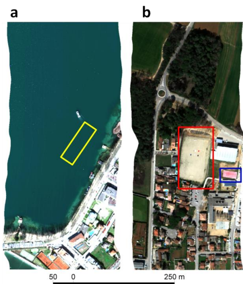
Figura 1. Composiciones RGB de imágenes CASI-550 tomadas el 15 de Marzo de 2013 sobre (a) el lago de Banyoles (Girona, España) y (b) sus alrededores. Localización de las medidas de campo sobre el lago (recuadro amarillo), las lonas y la arena (recuadro rojo), y el hormigón coloreado (recuadro azul).
