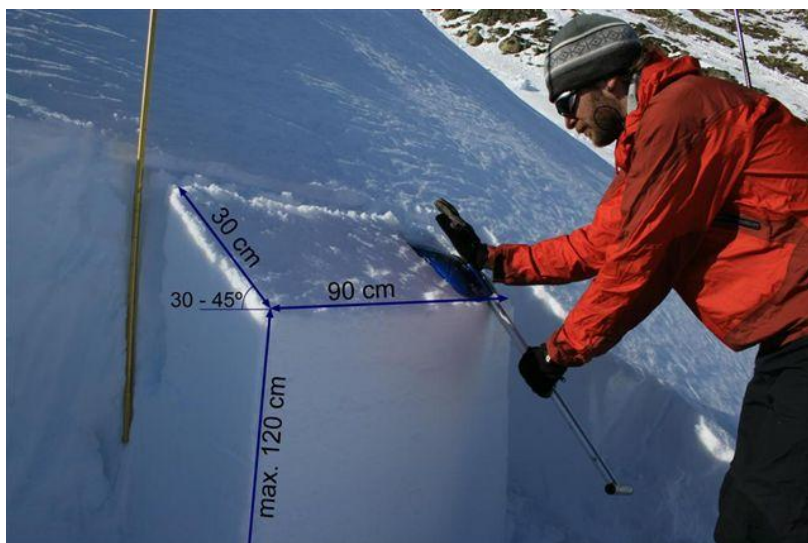
Figura 75: Mides del bloc a aïllar i zona on fer la sobrecàrrega. Autor: Jordi Gavalrà.
