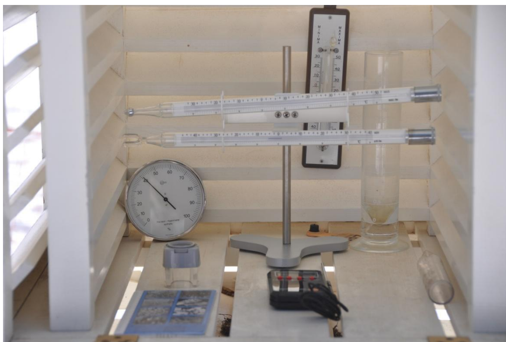
Figura 11: Interior d'una garita on s'aprecien els termòmetres de màxima i mínima sobre un suport metàl·lic.
