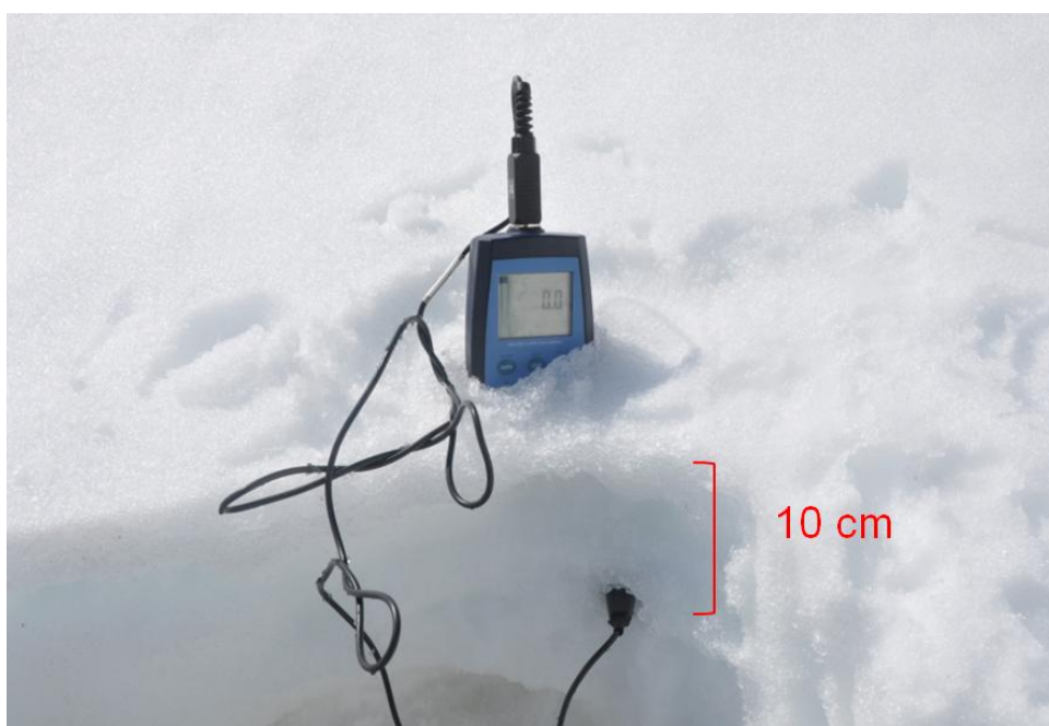
Figura 20: Mesura de la temperatura de la superfície de la neu; 10 cm per sota de la superfície i sempre a l'ombra.
