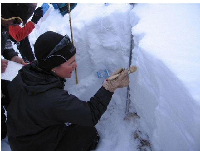
Figura 34: El pinzell ens servirà per fer ressaltar les capes més toves i les lleugerament més dures. Autor: foto dreta Jordi Gavaldà.
