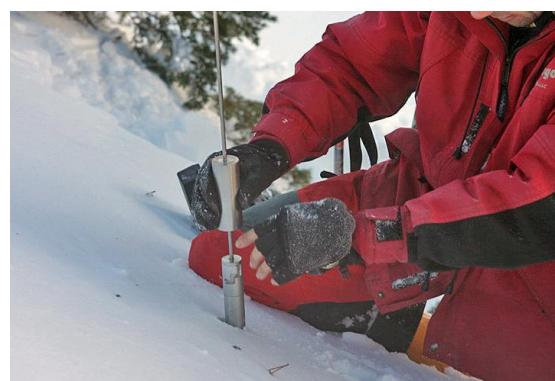
Figura 27: Introduint el pes mòbil amb molta cura. Autor: Ramon Baylina.
