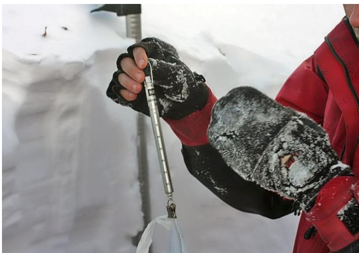
Figura 4: Presa de la densitat. Autor: Ramon Baylina.
