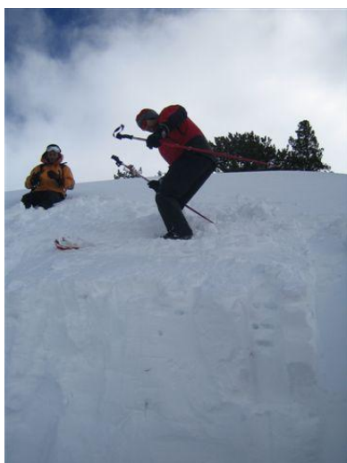
Figura 66: Si el bloc encara no llisca, farem una forta flexió amb els genolls. Si el bloc llisca en aquest estadi anotarem RB3.
