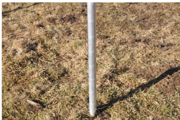
Figura 16: La perxa de gruix total de neu va clavada a l terra, on el zero coincideix amb la superfície del terreny.
