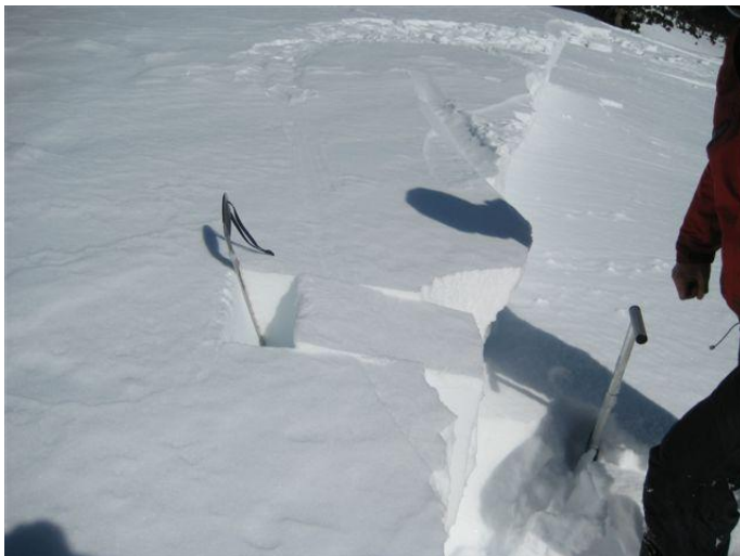
Figura 60: Test del pala en el que el bloc llisca mentre l'aïllem. S'anotaria TPmf. Autor: Ivan Moner.
