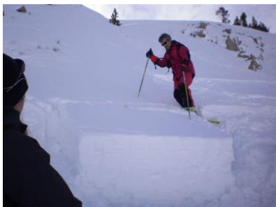
Figura 62: Les mides del bloc hauran de ser 2 m per 1.5 m.
