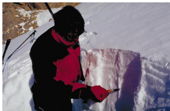
Figura 33: Amb la plaqueta, o millor amb una navalla, mirarem de sentir les diferents capes de neu. Autor: foto esquerra Ramon Baylina, foto dreta Conselh Generau d'Aran.
