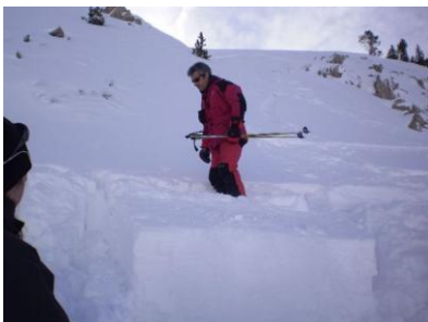
Figura 63: La sobrecàrrega es farà al centre del terç superior del bloc.
