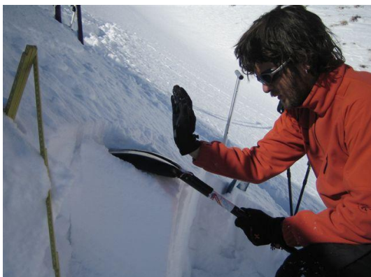
Figura 6: Colpejant al test de la columna estesa. Autor: Jordi Gavalrà.
