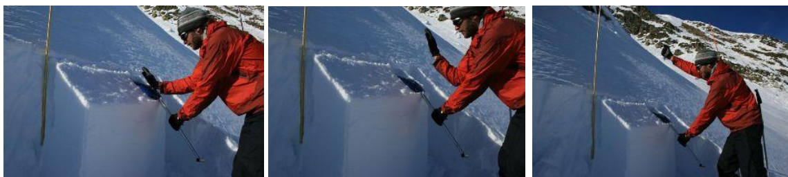
Figura 76: la sobrecàrrega es fa de la mateixa manera que el test de la compressió. A l'anterior apartat en teniu una descripció detallada. Autor: Jordi Gavalrà.
