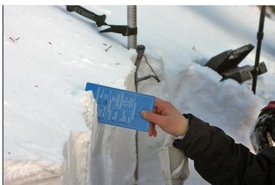
Figura 33: Amb la plaqueta, o millor amb una navalla, mirarem de sentir les diferents capes de neu. Autor: foto esquerra Ramon Baylina, foto dreta Conselh Generau d'Aran.
