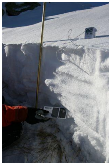
Figura 34: El pinzell ens servirà per fer ressaltar les capes més toves i les lleugerament més dures. Autor: foto dreta Jordi Gavaldà.
