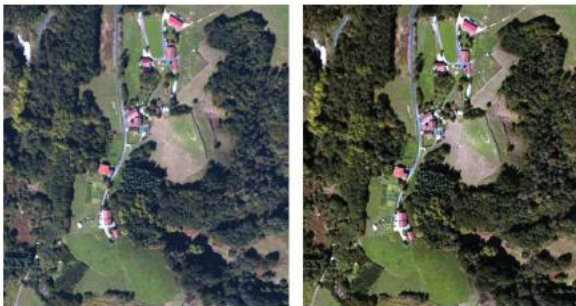
Vol sobre el País Basc. Imatge parcial d'una parcel·la sense correcció atmosfèrica (esquerra) i corregida (dreta).
