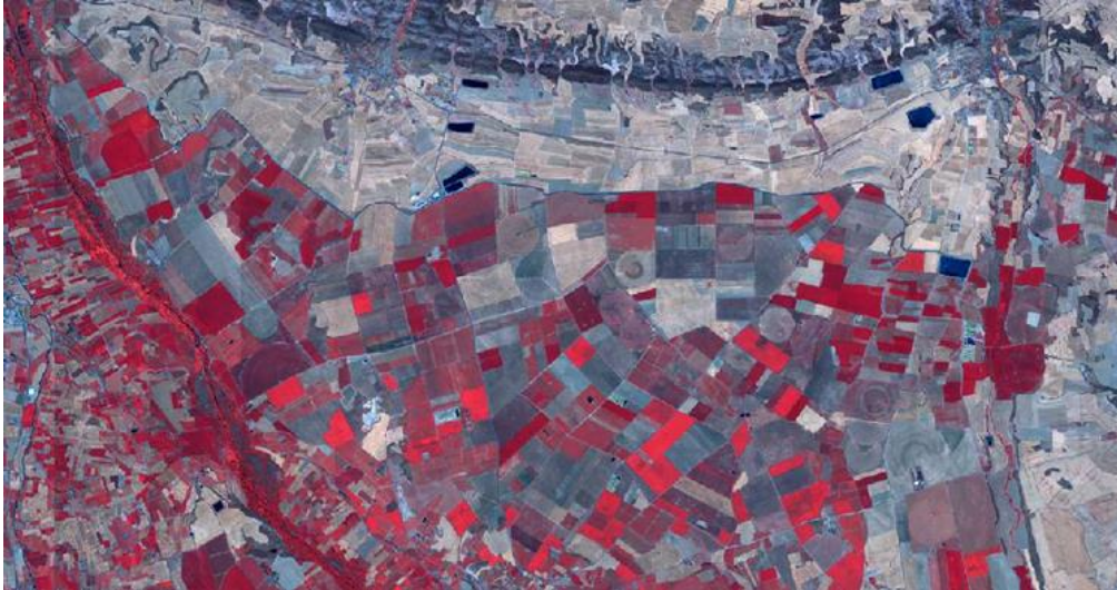
Observació de la Terra i campanyes de fertilització. Imatge Sentinel-2 en fals color per a l'elaboració d'índexs de vegetació en la zona d'estudi del projecte LIFE12 ENV-ES-00064.
