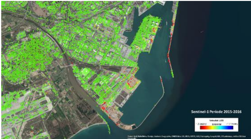
Interferometria SAR. Mapa de punts de deformació a la zona del Port de Barcelona obtinguts a partir del processament interferomètric del Sentinel 1a i 1b.
