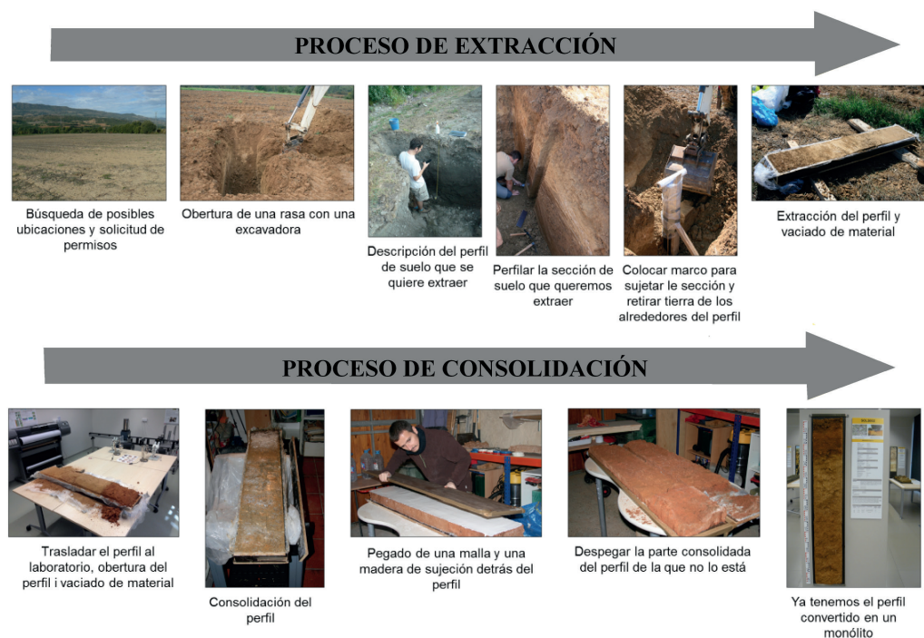
Figura 2. Imagen que ilustra y describe los procesos de extracción y consolidación de los monolitos.
