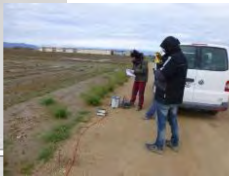
Perfils de tomografia elèctrica (ERT, en taronja) i de sísmica (blau)
