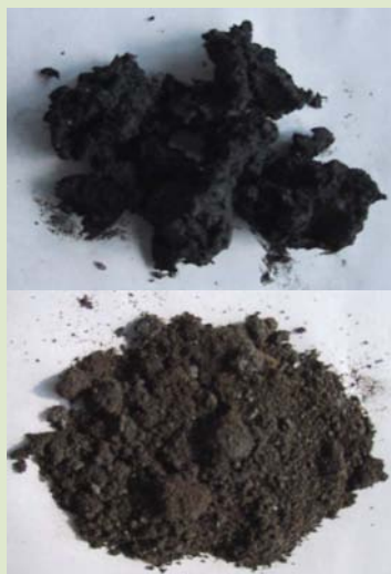
Fangs EDAR i biochar resultant (piròlisi lenta)
