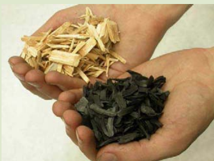
Estella de pi i biochar resultant per un procés de piròlisi lenta
