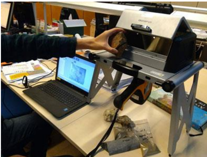
Posada en producció d'un equip portàtil de fluorescència de raigs X per a estudis geoquímics.
