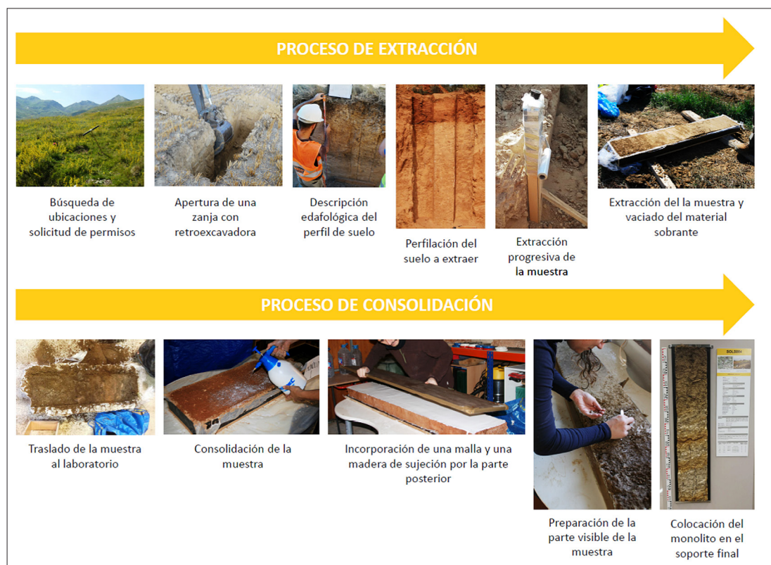
Fig. 1. El proceso de elaboración de los monolitos se realiza en dos fases, una primera de extracción en campo y una posterior de consolidación en el laboratorio.
