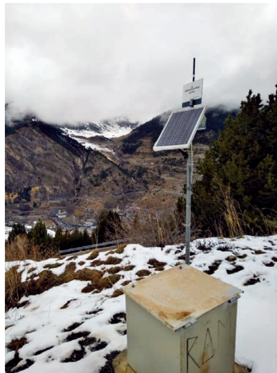
Figura 4.5. Sistema de auscultación del Gobierno de Andorra en el Forn de Canillo. Fuente: AR+I.
